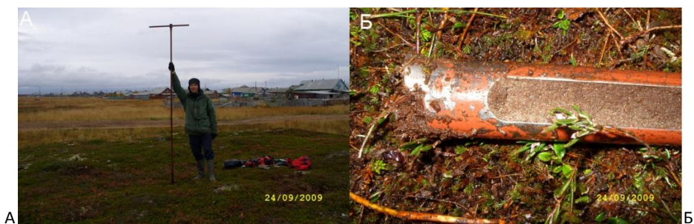
Рис. 2.2. Бурение скважины на миграционном бугре пучения: А — бурение, Б — керн, вскрывший немерзлый песок под слоем мерзлого торфа (фото С. А. Игловского, Н. Г. Скютте)
