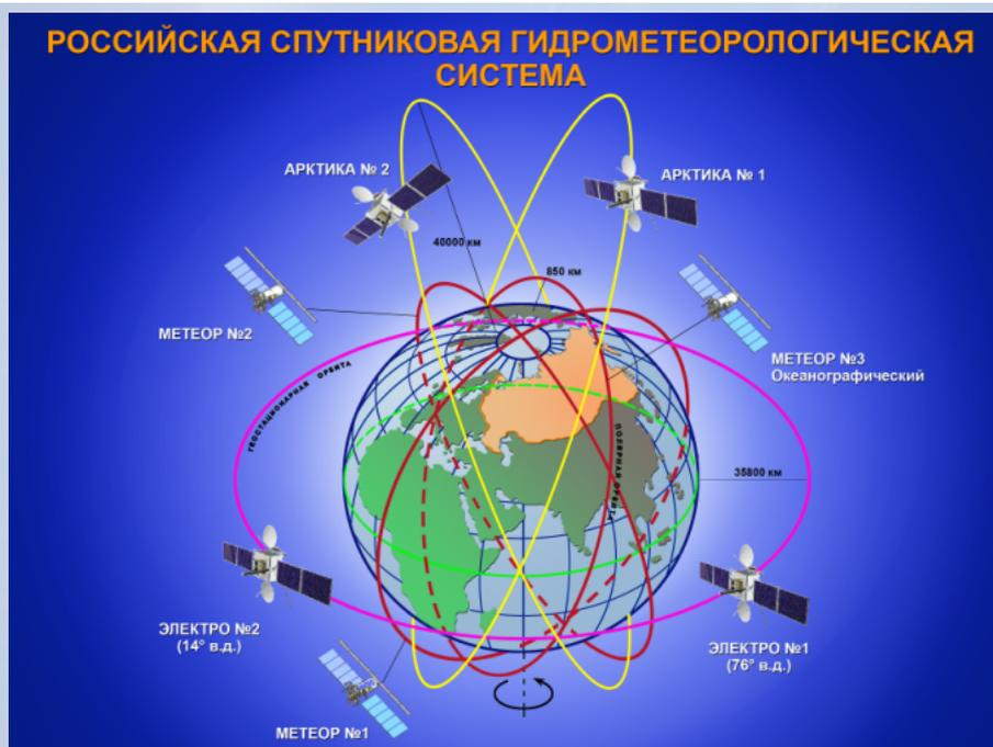
Важным мероприятием является создание до 2015 г. первой в мире высокоэллиптической гидрометеорологической многоцелевой космической системы (МКС) «Арктика» для мониторинга обстановки в северных полярных районах в интересах обеспечения безопасности трансарктических перелетов, навигации на СМП, хозяйственной деятельности на арктическом шельфе, а также для изучения климата.
