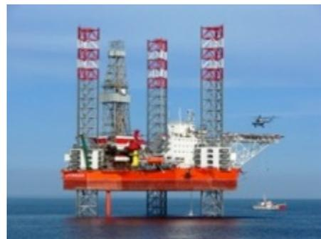
Рисунок 4. Самоподъёмная Буровая Установка (СПБУ) «Арктическая» в море
