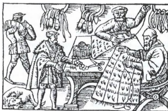
Рис. 5. Скорняжная обработка мехов (по Олаву Магнусу). Видны кольцевые бунты, мешки козицы и сшивание отдельных шкурок в большие полотна.
